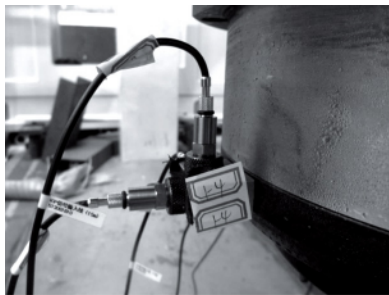
图5 测点处各方向传感器布置示意图
