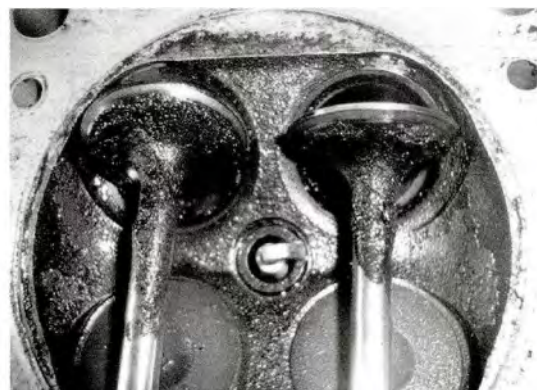
图 1 发动机气门积碳
