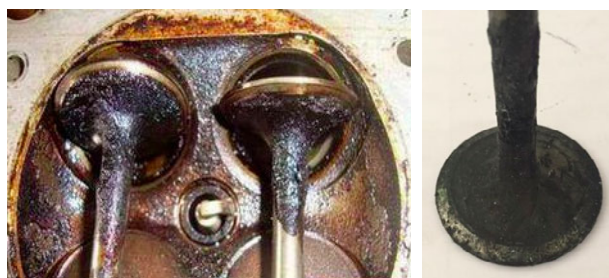
图 1 气门与气缸上的积碳
